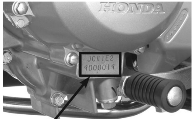
NÚMERO DE SÉRIE DO MOTOR NÚMERO DE IDENTIFICAÇÃO DO CARBURADOR
